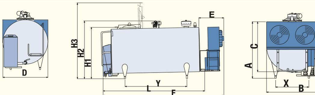
H1 = hauteur maximale avec agitateur, trou d'homme et event démontés
